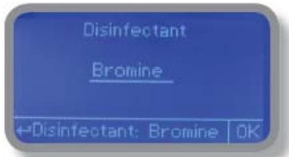
Drücken Sie den Dreh-Encoder um das Eingabefeld zu öffnen. Stellen Sie den gewünschten Wert ein und drücken Sie dann den Dreh-Encoder erneut, um den Wert abzuspeichern.
